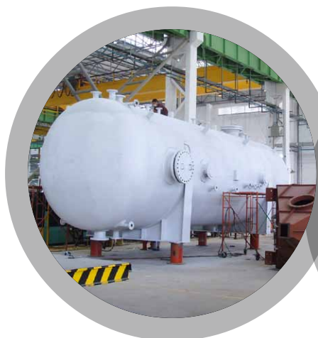
Tanques de retorno de condensados
