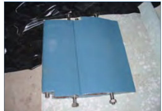
Leitschaufel nach Beschichtung mit Belzona 1341 (Supermetalglide)
