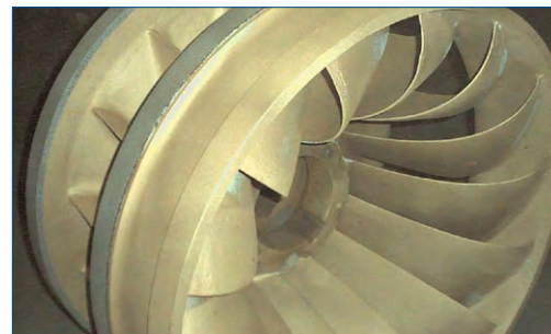
Francis-Turbine nach Sandstrahlen
