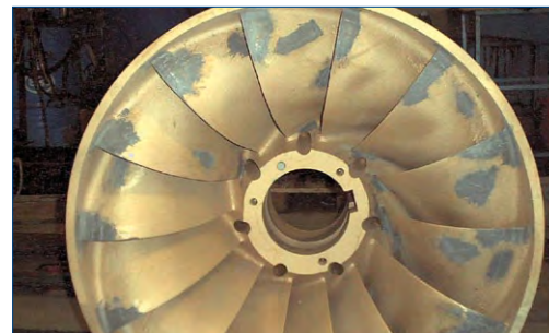
Belzona 1341 (Supermetalgilde) Einsatz am Laufrad
