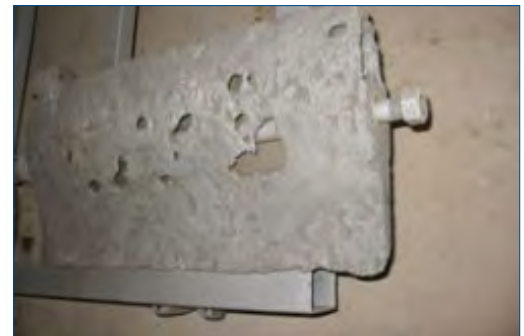
Leitschaufel nach Sandstrahlung
