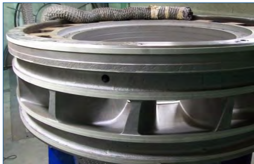
Gestrahltes Laufrad vor dem Einsatz
