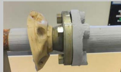
Após 1000 horas de exposição à atmosfera de névoa salina, nenhuma corrosão foi relatada sob o sistema de encapsulamento. Como comparação, a parte de aço que ficou exposta no final do flange apresentou alto nível de corrosão.
