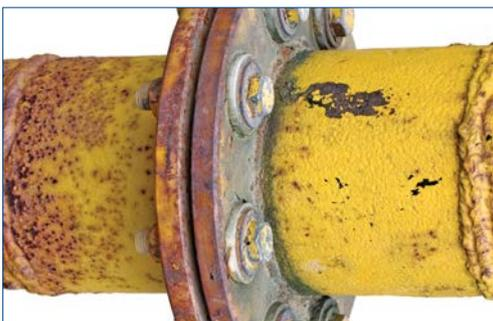
Corrosão generalizada em flange
